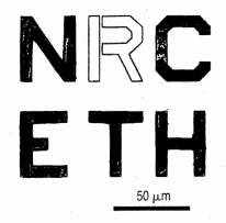
als (SiF<sub>6</sub>)<sup>2-</sup> ionisiert in Lösung geht. Die dabei entstehenden Löcher sind kleiner als 1 μm. Die porösen Bereiche haben die vom Ionenstrahl markierte Form und weisen Details von 300 nm Größe auf (s. Abb.). Wahrscheinlich kann man auf diese Weise sogar Strukturen herstellen, die kleiner als 100 nm sind. Bestrahlt man die porösen Bereiche mit einem Argonlaser, so leuchten sie orangerot auf. Durch Modifizierung des Ätzprozesses
